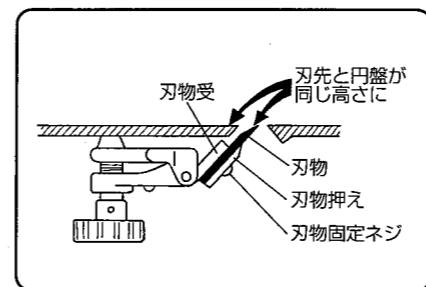
7 刃先が円盤上面と同じ高さで、平行になるようにして刃物固定ネジで固定してください。
