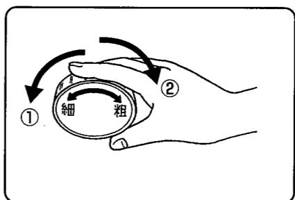
5 刀物調節ツマミを左へ一杯にまわしてから、右へ約半回転戻してください。
