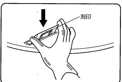
6 新しい刃物の「Hatsuyuki」という刻印が刃物押え側になるようにして円盤の上から刃物受と刃物押えの間に差し込んでください。
