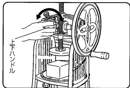
1 上下ハンドルを反時計方向に回して氷押えを上げます。
