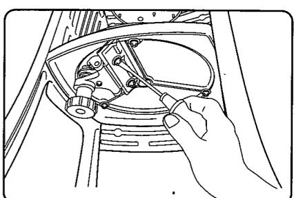
3 刀物固定ネジ(2本)をドライバーでゆるめてください。
