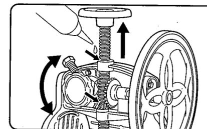
1 上下ハンドルを回し、主軸を上下させながら上部より軸受と主軸に給油してください。
