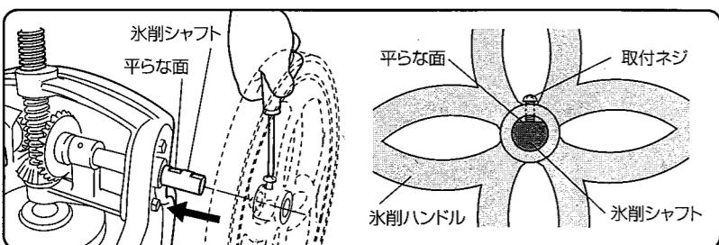
氷削ハンドルを製品に $\oplus$ ドライバーを使い、付属の取付ネジで取り付けてください。その際、取付ネジが氷削シャフトの平らな面と合うように締め付けてください。平らな面をネジで止めないと氷削ハンドルがすぐにガタ付きますのでご注意ください。
