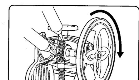
3 2個の歯車への給油は、上下ハンドルを下げ、氷削ハンドルを時計方向に回して歯車全体に給油してください。
