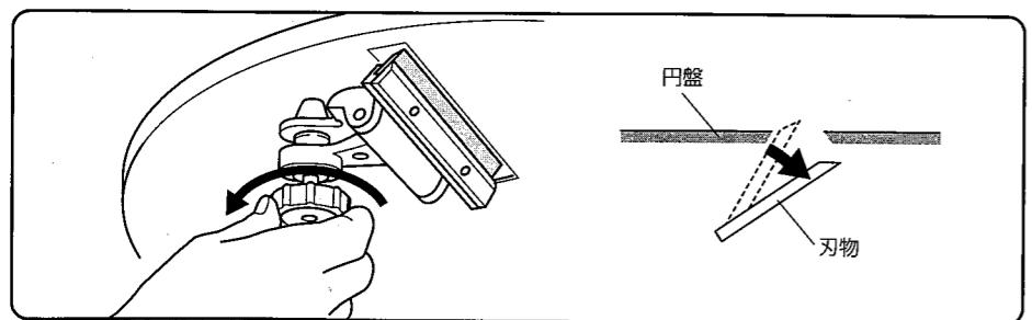
1 刃物調節ツマミを左へ一杯にまわして刃物を円盤上面より下げてください。
