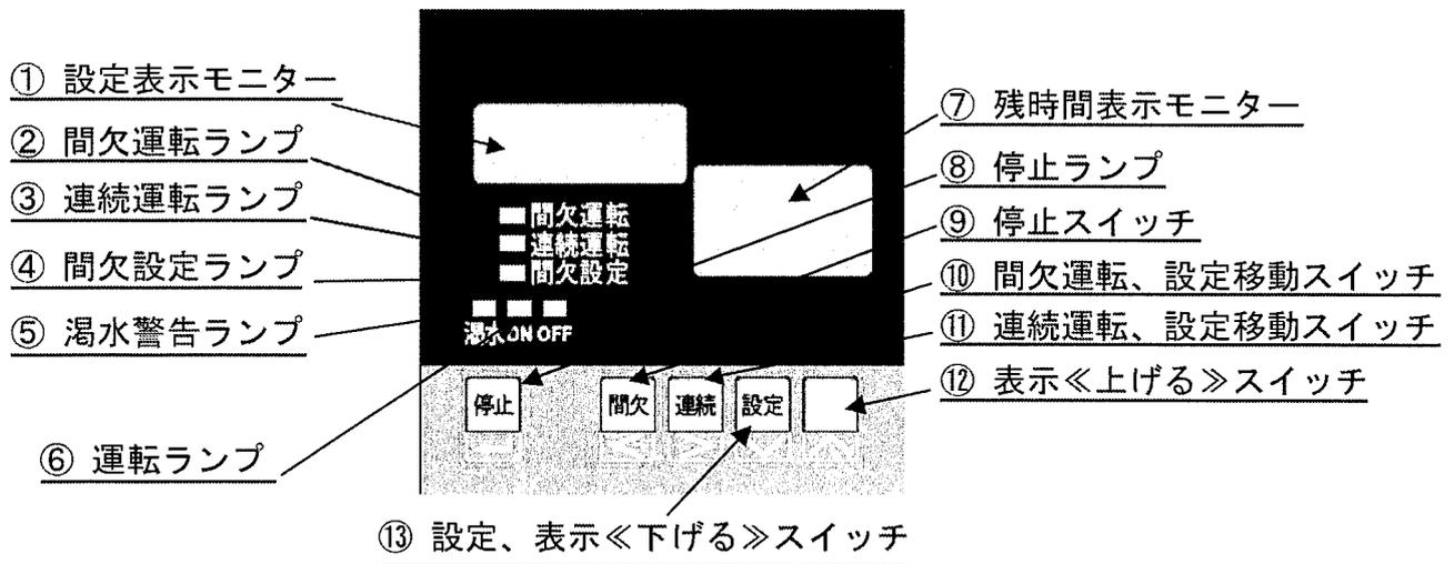
設定…………… ⑬設定スイッチを約5秒間押し続けてください。間欠運転の設定ができます。
